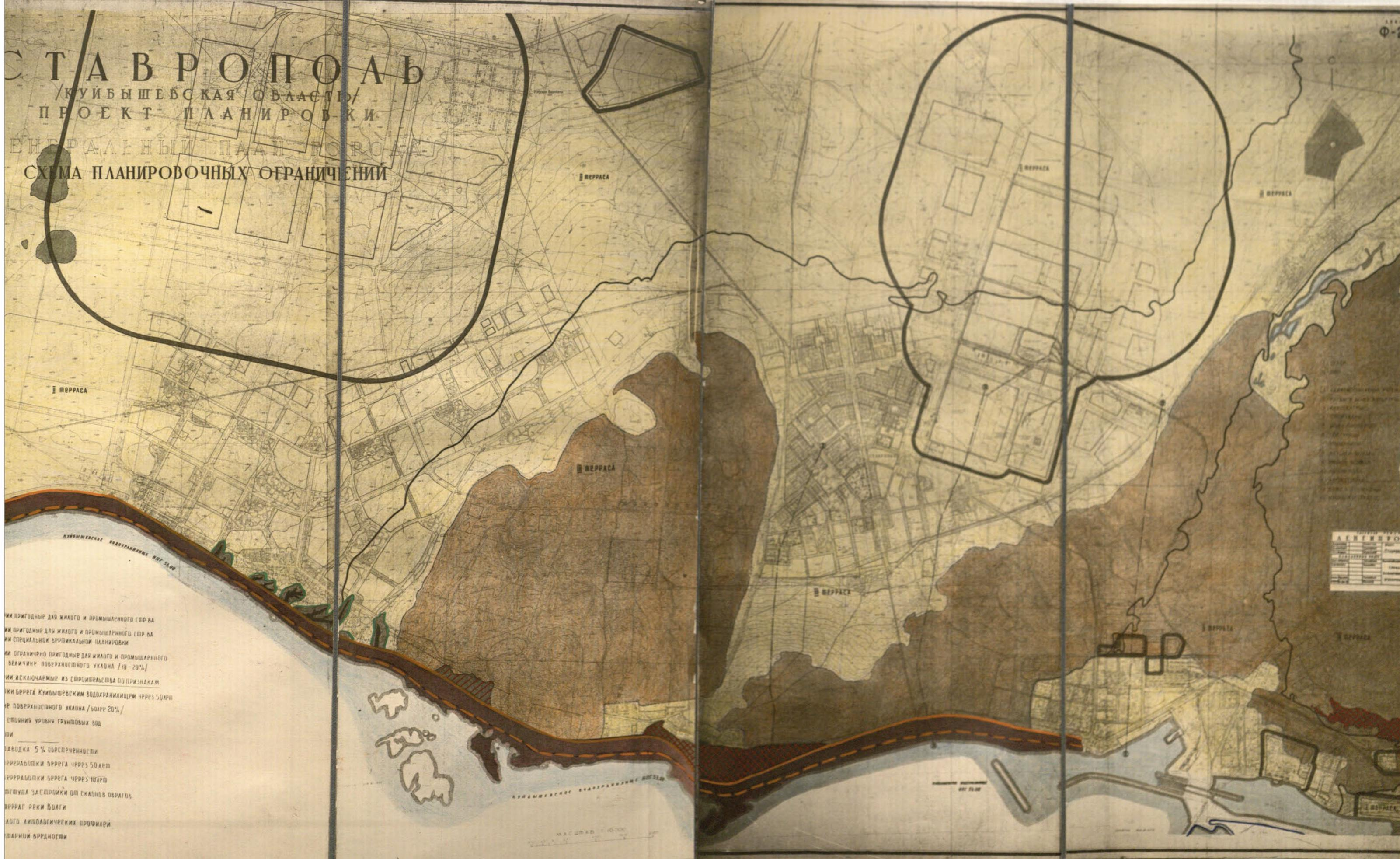
По гидрологическим условиям эти участки не вызывают планировочных ограничений. Несущая способность пород, залегающих в зоне заложения фундаментов зданий определяется порядком 2 кг/кв.см.
