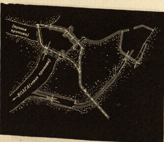
Компоновка Саратовского гидроузла с вариантами размещения гидростанции
